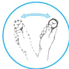
*\* Il n'est pas nécessaire de recharger la montre à fond car elle se recharge automatiquement lorsqu'elle est portée au poignet.*
